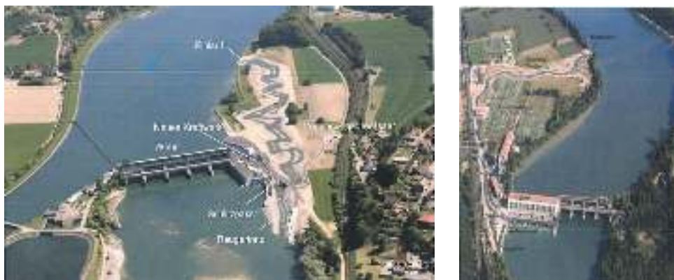
Slika 106: Umestitev prehodov za ribe pri HE Albruck-Dogern (levo) in HE Ryburg-Swörstadt (desno) (vir: ing. Büro dr. Gebler, Verbindungsgewässer).
